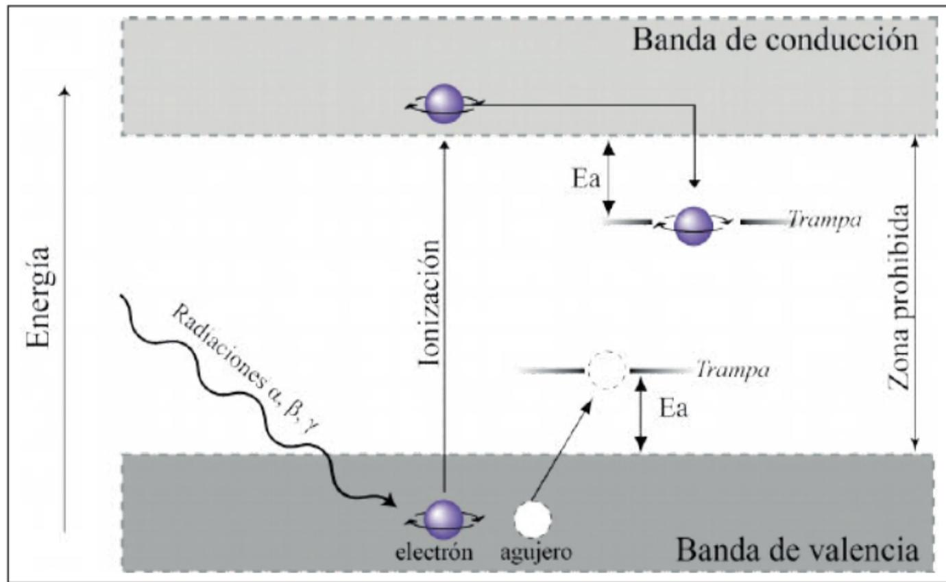
**Figura 7.4.** Proceso de creación de centros paramagnéticos según el modelo de la teoría de bandas.  $E_a$  es la energía de activación.
